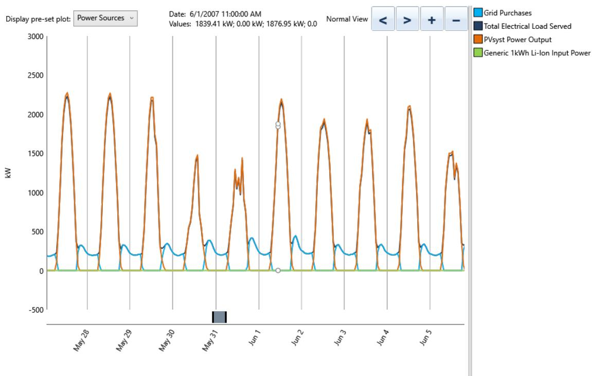
Figura 5.9 Operación del sistema eléctrico (Escenario 3-BESS 875 kWh)
